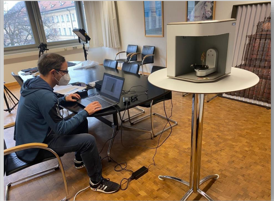
Digitalisierung der Agraft im Bayerischen Nationalmuseum mit dem 3D-Scanner Artec Mirco , der Form und Farbe erfasst.
